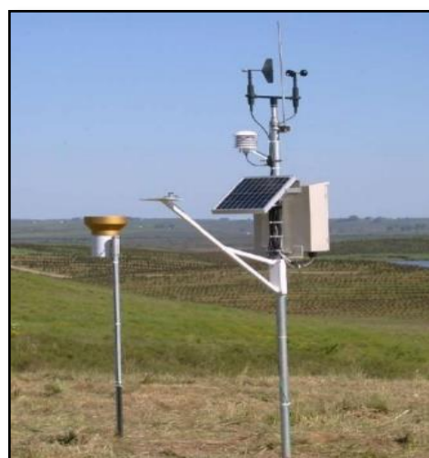
Estação meteorológica. Esses sensores são capazes de registrar a temperatura do ar, a velocidade e direção do vento, a umidade do ar, a radiação solar, a chuva, a pressão atmosférica. entre outras variáveis.
