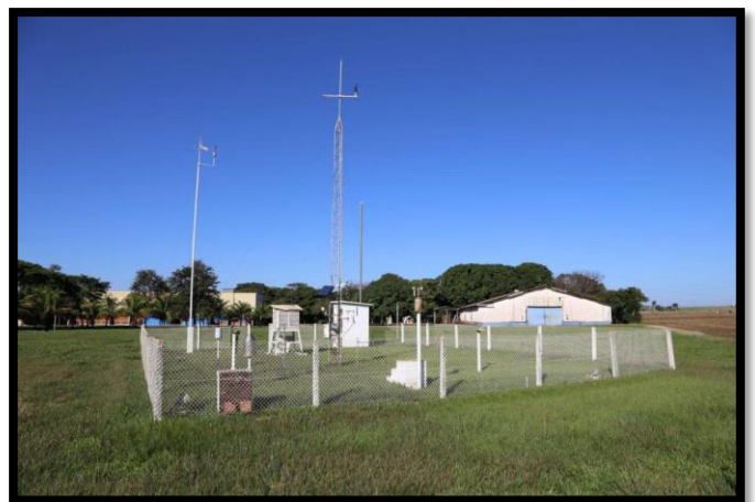
Foto de uma estação meteorológica automática: os aparelhos de medição ficam demarcados, e os dados são enviados via satélite para a base de operação.
